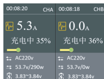
c) 随着CHA电流增加,其电压逐步增加,待电压接近CHB电压时,逐步降低CHA电流;
