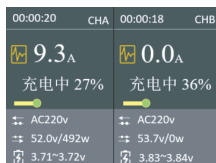
b) 电压较低者(CHA)先开始增加电流,电压较高者(CHB)暂时无电流;
